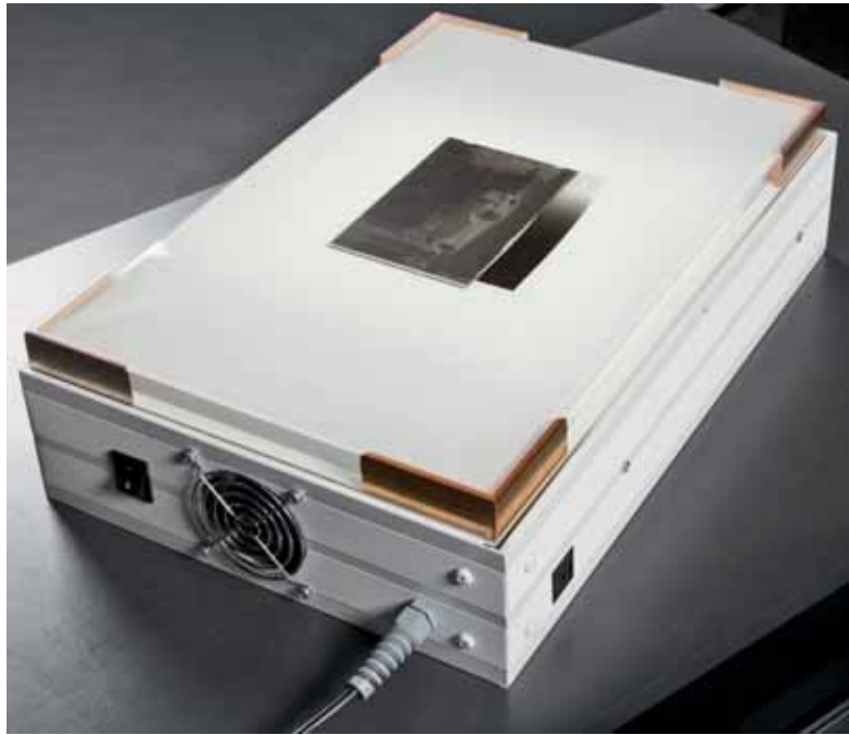
Erityisrakenteinen valopöytä transparenttiaineiston kuvaamiseen. Valopöydässä päivänvaloloihiteputket valonlähteenä, tuuletin, ilmanpoistoaukot ja pöydän pinnasta irtinostettu maitolasi.
