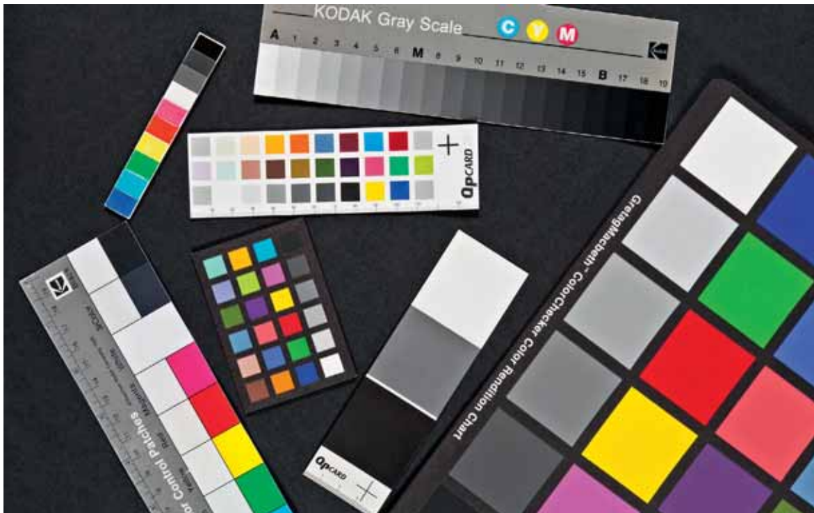
Kuvauksessa käytettäviä väri- ja harmaasävykiiloja, joilla kontrolloidaan sävyjen ja värien toistumista.
